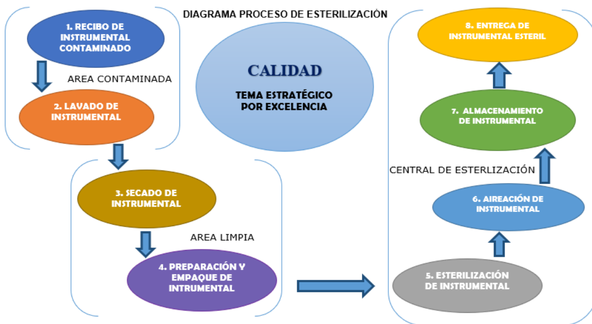
Gráfica No. 8: Diagrama del Proceso de Esterilización.
