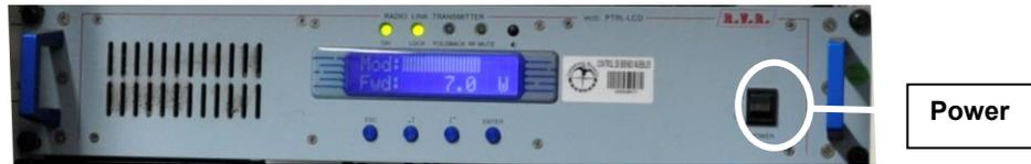
➤ **Paso 3.** Encender consola marca AXIA enchufando el cable de poder en el módulo.
